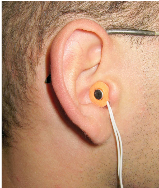
Abbildung 3.12: Mit Miniaturmikrofon im geblockten Ohrkanal präpariertes Ohr zur Messung des Kopfhörerfrequenzgangs.
