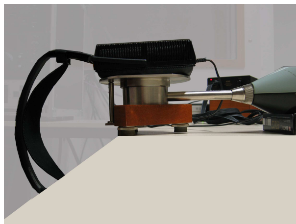
Abbildung 3.23: Kopfhörer KH1 auf Ohrsimulator B&K 4153 mit Schallpegelmesser B&K 2231.
